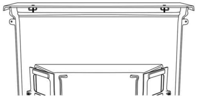
Вид сзади с прикрепленной каминной полкой. Установите 3 крепежные С-скобы в пазы на камине. Поместите полку на камин и вставьте два болта М8 в отверстия на полке таким образом, чтобы они проходили через крепежные выступы (рис.3) и С-скобы с обратной стороны камина. Для затягивания следует использовать плоскую отвертку.
