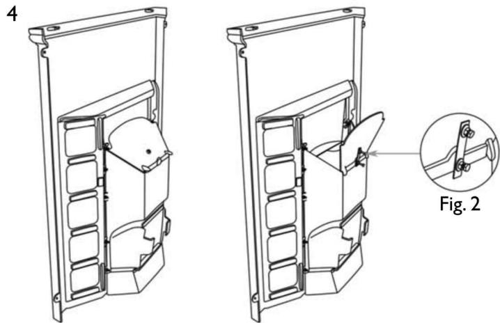
Использование твердого топлива: вставьте заслонку в пазы с обратной стороны топливника. При горении дров заслонка всегда должна быть открыта. Для этого используйте набор деталей для крепежа заслонки. Навинтите гайку M6 полностью на болт M6 и только затем 2 шайбы M6. Зафиксируйте пластину для крепления заслонки как изображено на рис.2
