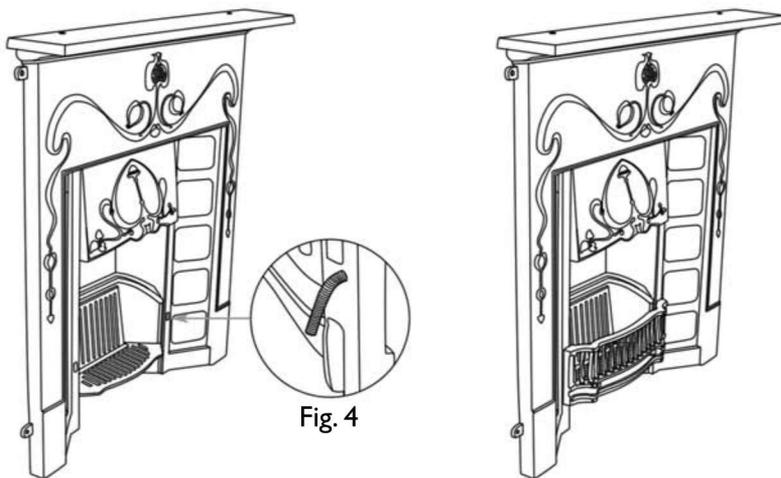
Зафиксируйте 2 крепежные шпильки с обратной стороны декоративной решетки (рис.4). Прикрепите декоративную решетку к дровнику с помощью двух крепежных шпилек.
