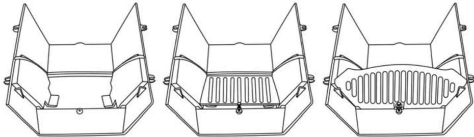
Положите топливник на ровную поверхность. Поместите огнеупорный камень на место и затем вставьте 1 болт M6 в отверстие прямо под ним. Вставьте колосник в пазы топливника над гайкой M6. Закрепите с помощью шайбы M6 и болта M6. В случае использования газа этот шаг не требуется.
